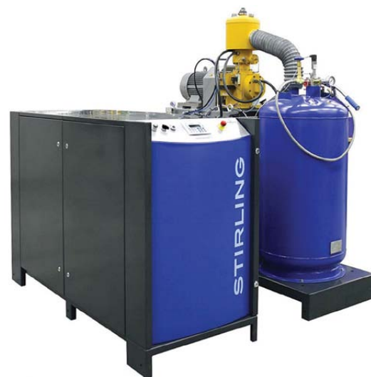
Rys. 3. Instalacja skraplania ciekłego azotu (LN 2 ) o wydajności 120 kg/dobę ze zbiornikiem 200 litrowym. Zapotrzebowanie energii: 13 kW (Stirling Cryogenics)
