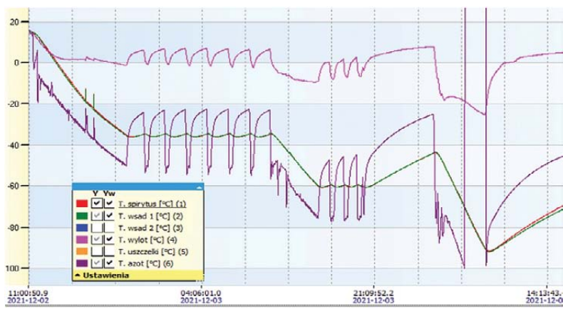
Rys. 8. Badanie innowacyjnej instalacji przechowywania. Temperatura wsadu – kolor zielony. Wykres z danych ze sterownika i rejestratora firmy SIMEX
