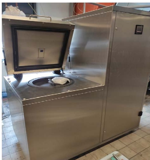
Rys. 7. Prototyp innowacyjnej instalacji do przechowywania szczepionek w niskich temperaturach (ANC-BWM)
